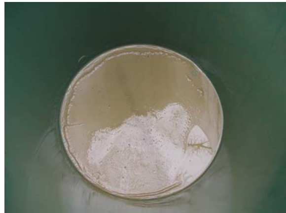
Abb. B.21: Links: Organische Feststoffe (insbesondere zerleinerte Äste und Stöcke) die sich nach dem Einstau in Form eines Spülsaumes abgelagert haben. Rechts: Gräulich-bräunliches Hochwassersediment nach dem Abpumpen des Hochwasserüberstandes.
