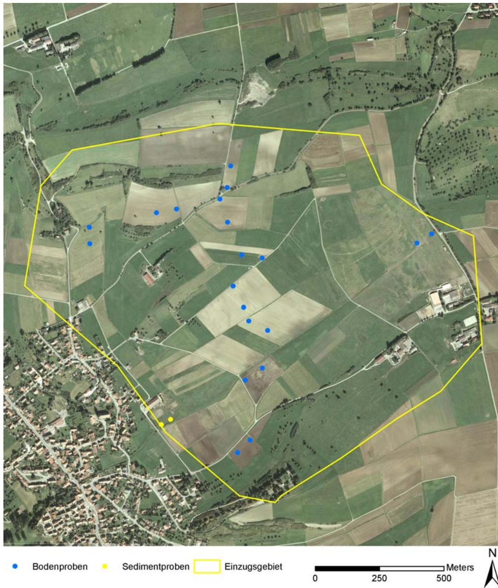
Abb. B.41: Einzugsgebiet des HRB Grosselfingen mit den Standorten der Boden- (blaue Punkte) und Sedimentprobenahmestellen (gelbe Punkte).
