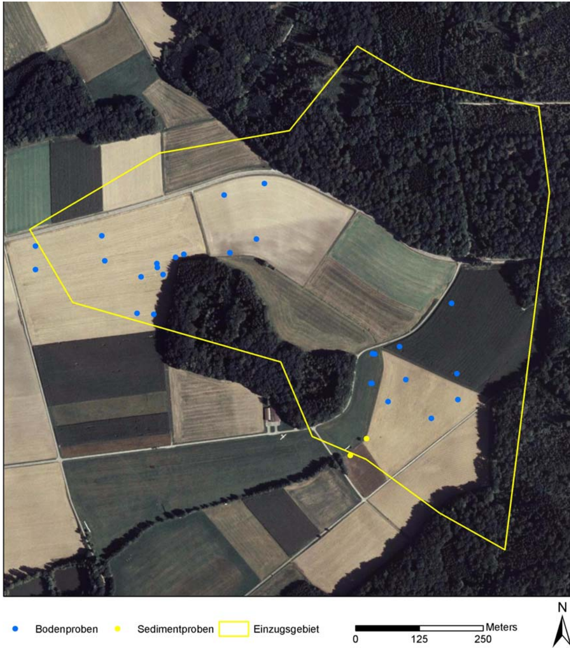
Abb. B.26: Einzugsgebiet des HRB Hermuthausen mit den Standorten der Boden- (blaue Punkte) und Sedimentprobenahmestellen (gelbe Punkte).
