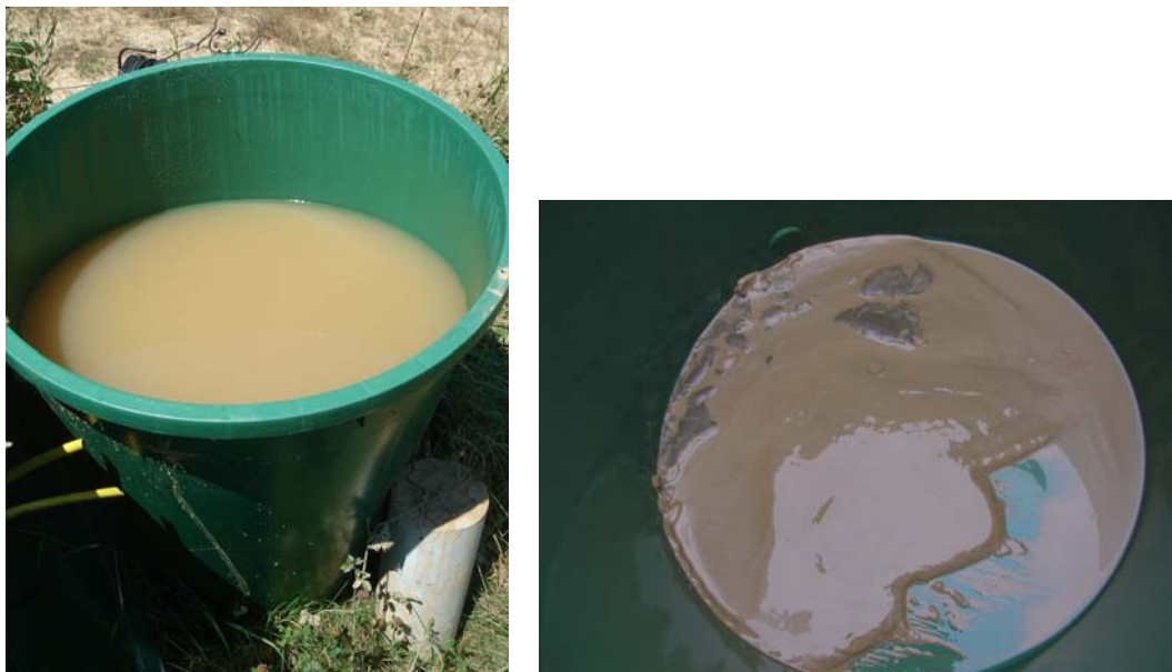
Abb. B.5: Links: Hochwasserprobe mit hohem Feststoffgehalt und bräunlich-mineralischer Färbung. Rechts: Hochwassersediment nach dem Abpumpen des Hochwasserüberstandes.
