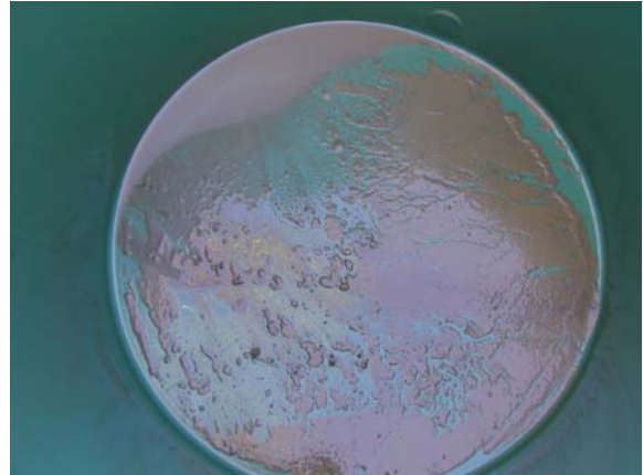
Abb. B.40: Links: Durchsichtiger, Mineralisch-bräunlich gefärbter Hochwasserüberstand nach dem Absedimentieren. Rechts: Mineralisch-bräunlich gefärbtes Hochwassersediment nach dem Abpumpen des Hochwasserüberstandes.
