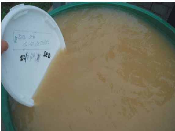
Abb. B.10: Links: Hochwasserprobe mit hohem Feststoffgehalt und bräunlich-mineralischer Färbung. Rechts: Abgelagerte Hochwassersedimentschichten im Stauraum des HRB.
