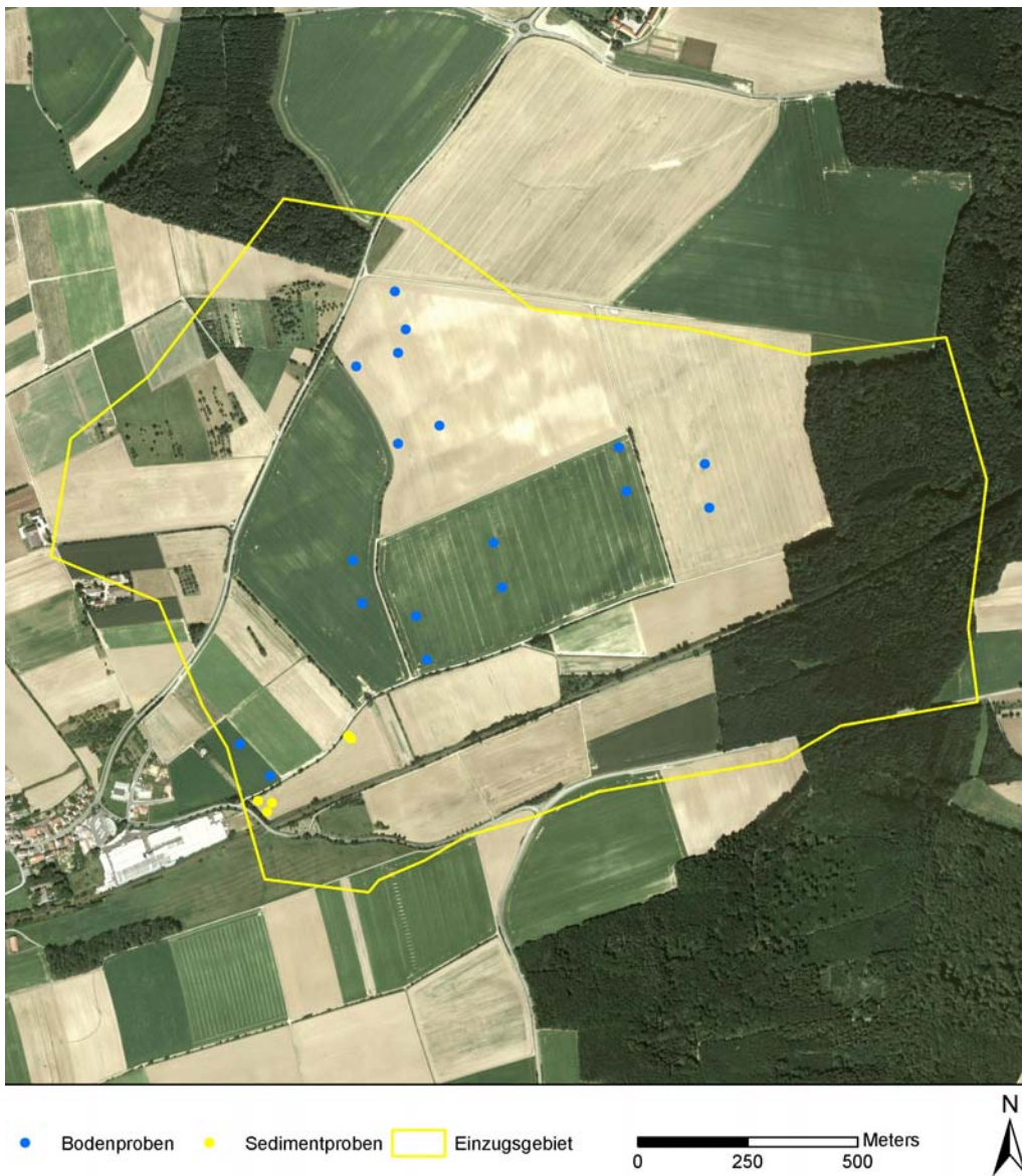
Abb. B.7: Einzugsgebiet des HRB Grombach mit den Standorten der Boden- (blaue Punkte) und Sedimentprobenahmestellen (gelbe Punkte). Auf der großen hellshattierten Ackerfläche im nördlichen Einzugsgebiet sind deutlich großflächige Erosionsspuren und die dazugehörigen Abflussrinnen zu erkennen.
