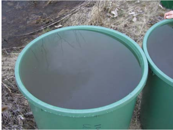
Abb. B.36: Links: Durchsichtiger, organisch-bräunlich gefärbter Hochwasserüberstand nach dem Absedimentieren. Rechts: Organisch-bräunlich gefärbtes Hochwassersediment nach dem Abpumpen des Hochwasserüberstandes.
