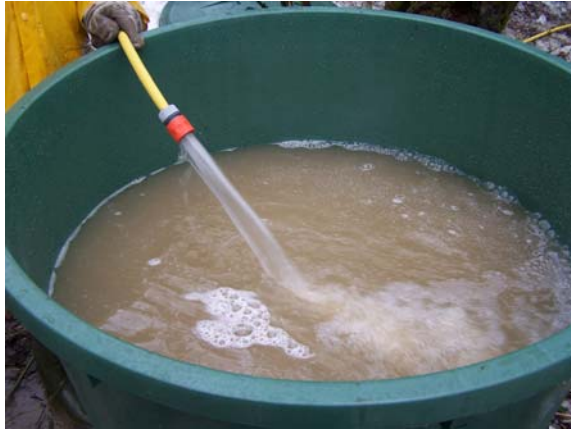
Abb. B.20: Links: Bräunlich-mineralische Farbe des Hochwassers beim Befüllen des Probenehmers. Rechts: Deutlich hellere Farbe des Hochwasserüberstandes nach dem Absedimentieren.
