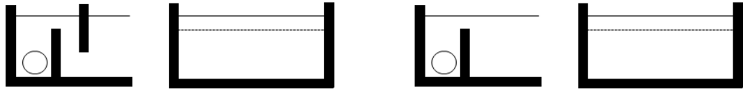
Abbildung 9: Rückbaumaßnahme einer zulaufseitigen Tauchwand mit dem Ziel der Vermeidung von Remobilisierungsprozessen verursacht durch erhöhte sohnnahe Fließgeschwindigkeiten
