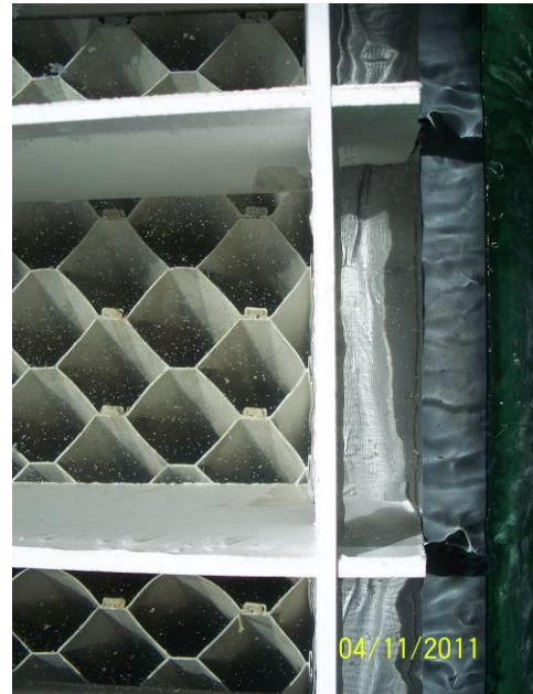
Abbildung 14 a und b: Links Anordnung von Trenn- und Tauchwänden über den Wabepaketeten bei den ersten Versuchen. Rechts Detailansicht der seitlichen Überfallschwelle während eines Versuchs
