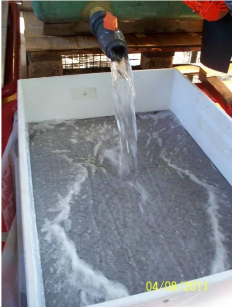
Abbildung 16: Entleeren des Wanneninhaltes durch ein Auffangsieb. Das aufgefangene weiße Modellsediment ist deutlich erkennbar.
