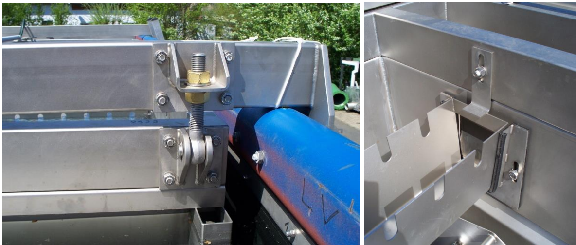
Abbildung 39: Aufhängung und Rinnensystem (Quelle: UFT 2012)
