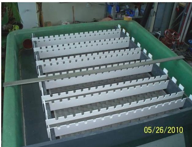
Abbildung 15 a und b: Einbau der 6 Ablaufrinnen über den Wabepaketeten, rechts Probelauf (der im Foto eingblendeten Aufnahmetag ist falsch, die Bilder sind vom Juni 2011)
