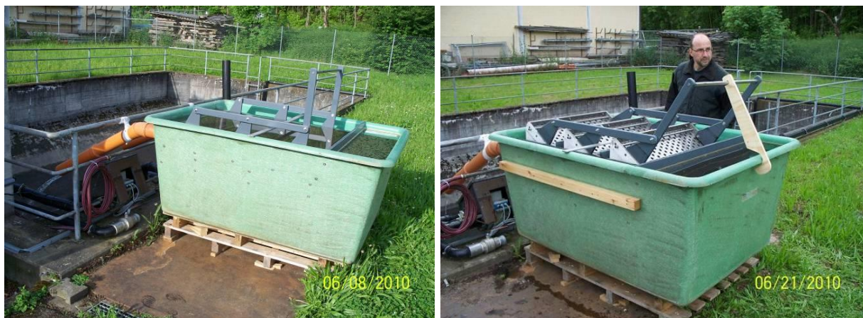
Abbildung 4: Schrägklärer-Pilotanlage im Einsatz am RKB „Abelt“ im Sommer 2010 (Vorversuche durch UFT, noch außerhalb des vorliegenden Projektes). Links Betriebsstellung, rechts Abreinigungsstellung. Über den Schrägklärerwaben war bei diesen Versuchen ein Lochblech zur Vergleichmäßigung der Durchströmung angeordnet.
