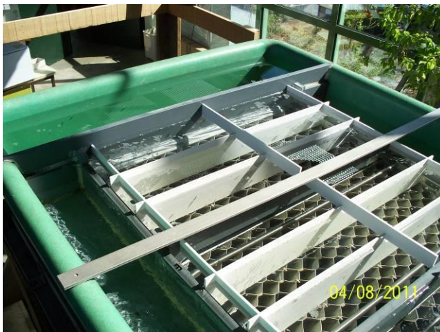
Abbildung 14 a und b: Links Anordnung von Trenn- und Tauchwänden über den Wabepaketeten bei den ersten Versuchen. Rechts Detailansicht der seitlichen Überfallschwelle während eines Versuchs
