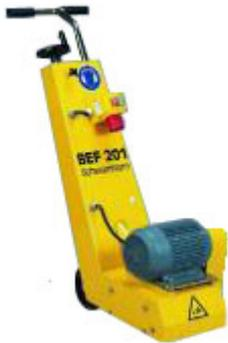
(Abb: Feinfräse für eine glatte Oberfläche des Betonuntergrunds)
