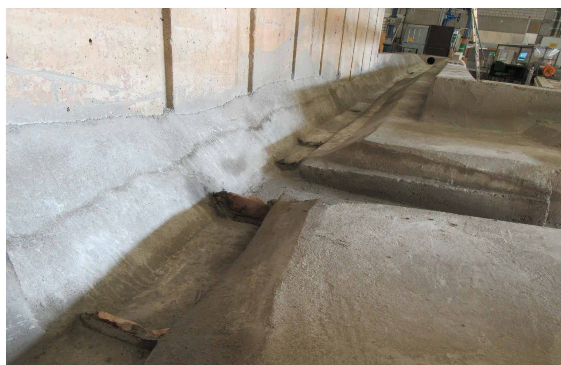
Physikalisches Modell des Bahn- und Straßendurchlasses; Quelle: IWG/KIT
