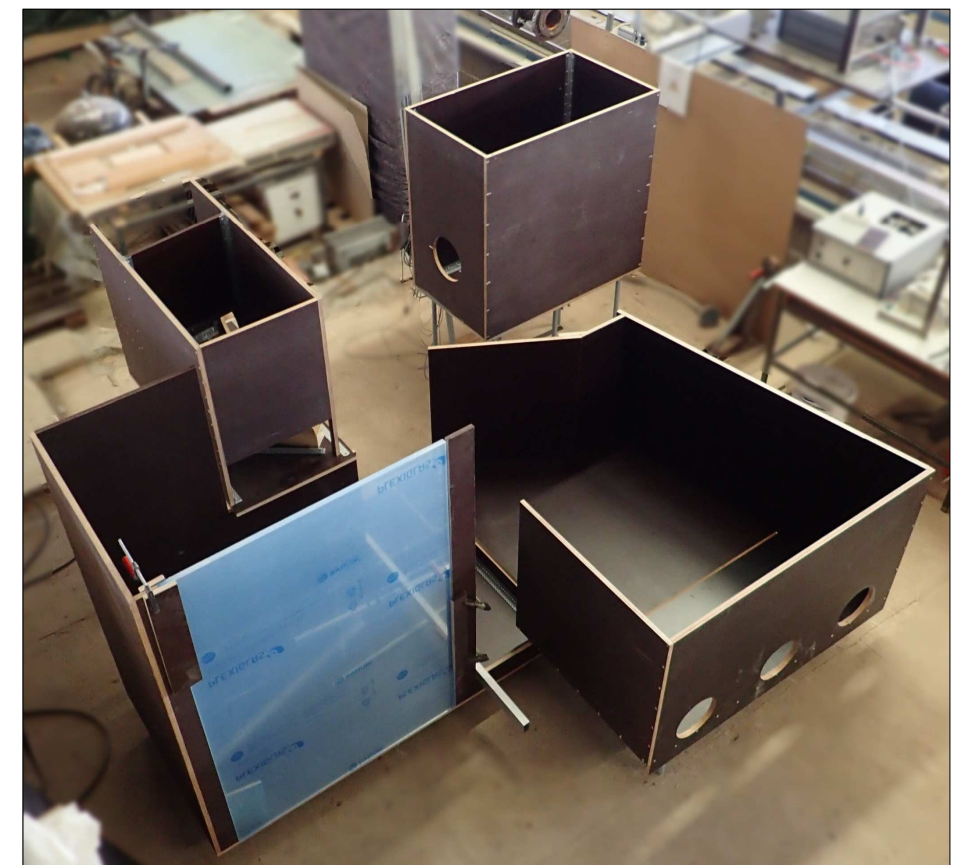
Blick von oben auf das Modell während des Aufbaus. Im Vordergrund links ist der Energieumwandlungsschacht zu sehen
