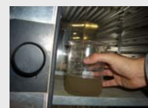
Trocknen der Suspension im Trockenschrank.
