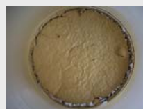
Getrocknete Probe. Bestimmung der Sedimentmenge durch auswiegen.
