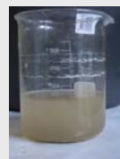
Die Sedimentsuspension wird im Messbecher gesammelt.
