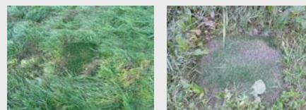
Matte nahe am Hauptgerinne ausgelegt, hohe Fließgeschwindigkeiten, kaum Sedimentablagerungen
