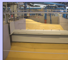
Fertiger Modellaufbau mit Wehrfeld
